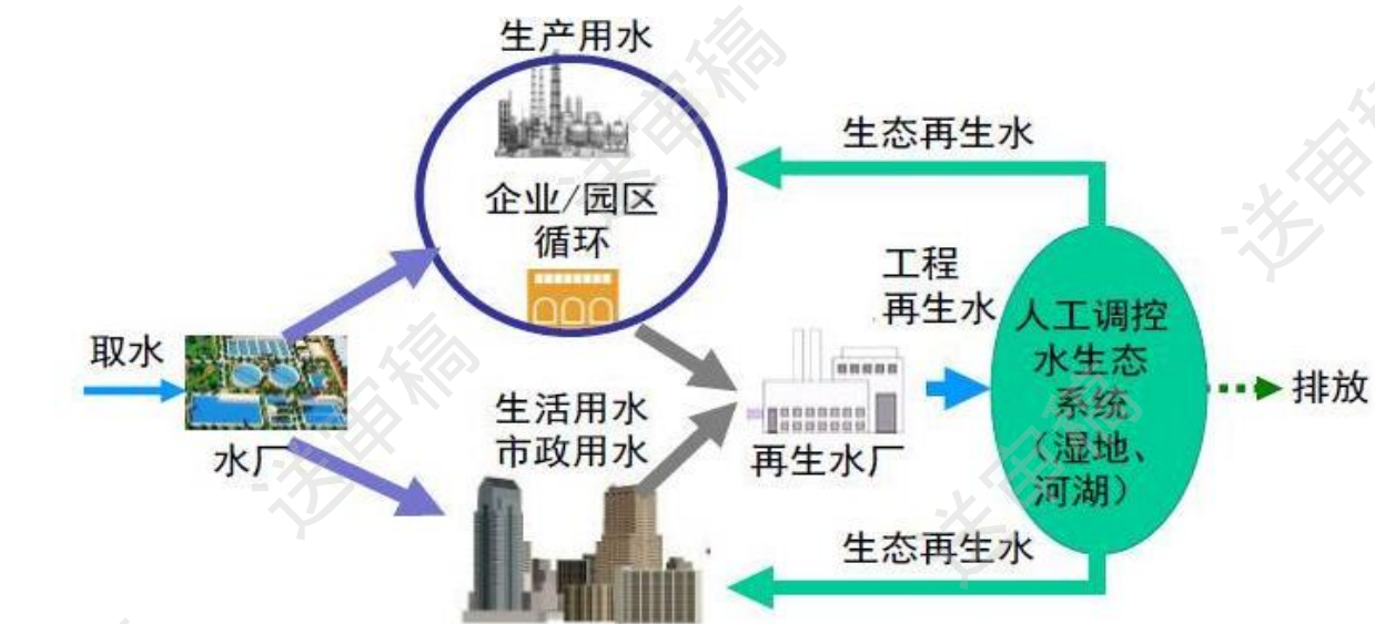
图6-3 区域再生水循环利用系统模式
